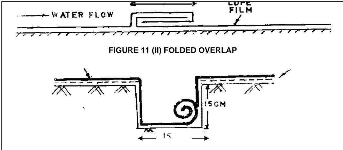
FIGURE 11(iii) FOLDED JOINTS EMBEDDED IN A TRENCH TO FACILITATE LINING
